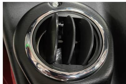
Painel de instrumentos com saída de aquecedor orientável
